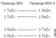
Рисунок 56: Прямая кабельная разводка для подключения к концентратору, повторителю или коммутатору
