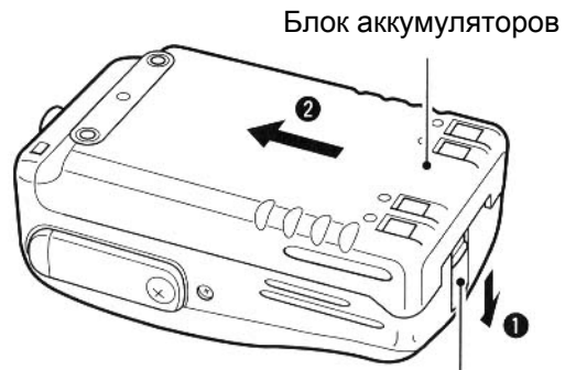
Кнопка освобождения блока аккумуляторов
