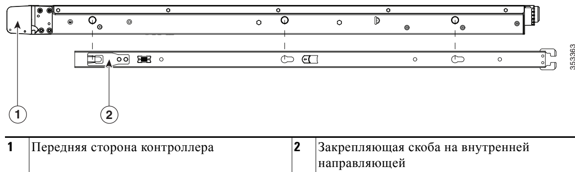
Рис. 2-1 Установка внутренней направляющей на боковой стенке контроллера
