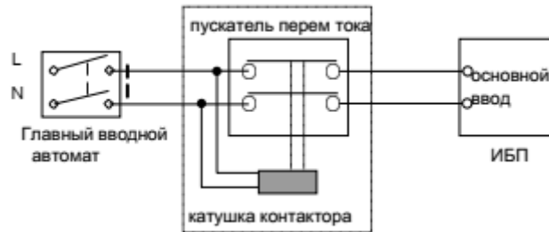
Рис.1 Типовая установка внешнего изолирующего устройства
