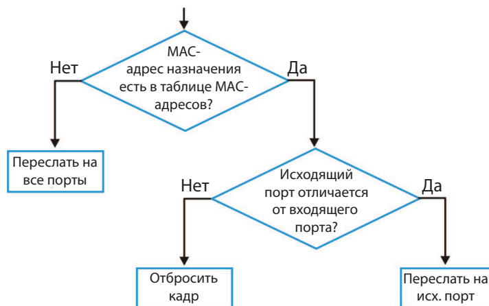
Рисунок 255 Схема работы таблицы MAC-адресов
