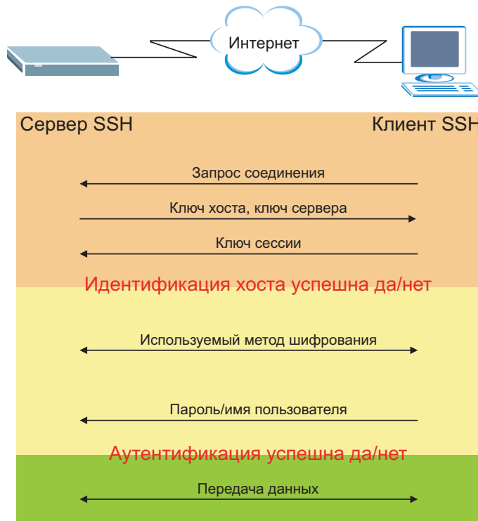
Рисунок 238 Как работает протокол SSH
